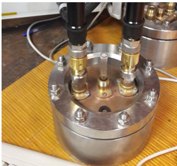
Рисунок 20 - Отверстие внутри резонатора с кварцевой колбой для помещения внутрь образца угля
